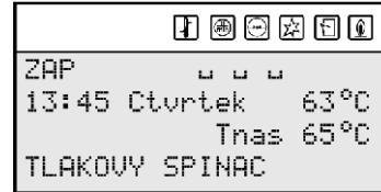
4. Po nějaké době větrání přestane a elektronické zařízení sníží počet otáček ventilátoru na počet určený pro zapalování. poté začne (před)žhavení zapalovače žhavení.
